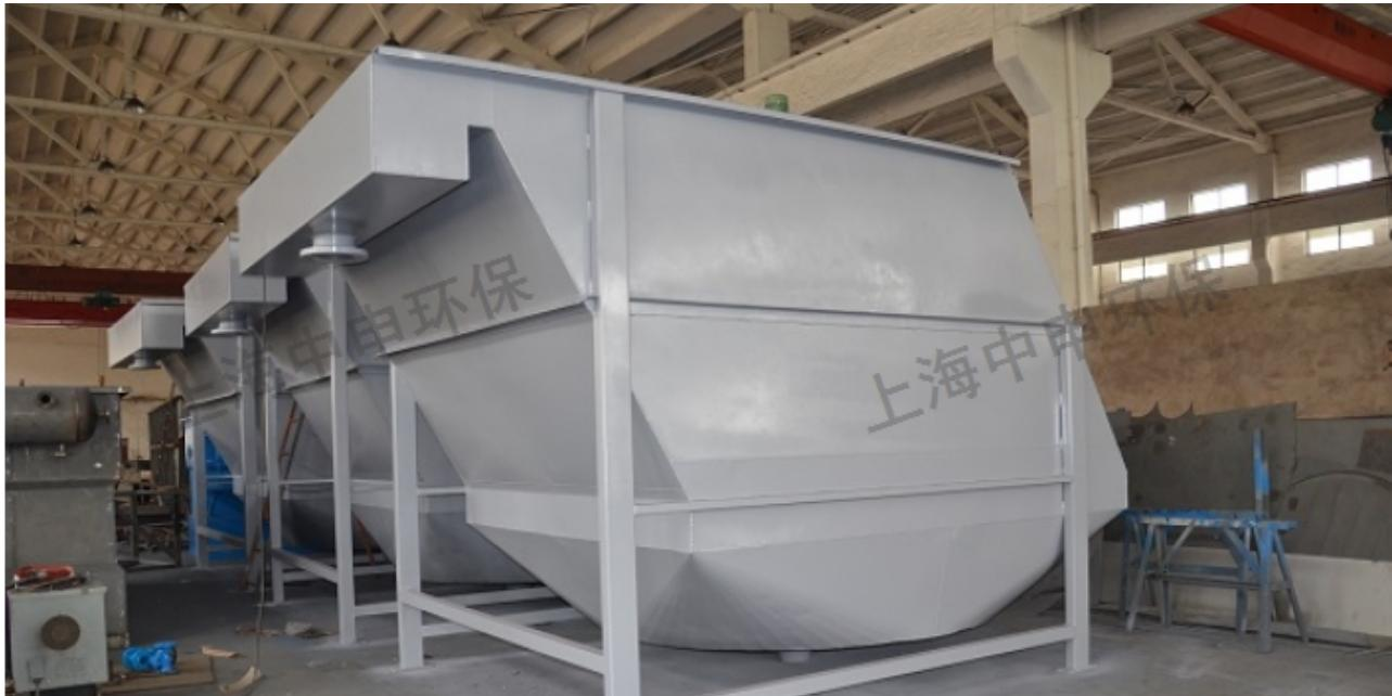
平流式沉淀池沉淀效果，除受反应效果的影响外，与池中水平流速、沉淀时间、原水凝聚颗粒的沉降速度、进出口布置形式及排泥效果等因素有关。一般流速不大于，停留时间 $2h$ 水流部分的有效水深不超过 $3m$ 池的长宽比不小于4。沉淀池的出水装置常采用三角堰、孔眼和溢流堰等，一般出水堰做成由直角三角堰构成的锯齿形堰口，齿深常用 $5cm$ 齿距用 $20cm$ 左右。如沉淀池容积不大，底部也可做成许多污泥斗，泥斗的斜壁与水平面的倾角，方斗宜为 $60^\circ$ ，圆斗宜为 $55^\circ$ 。平流式沉淀池的优点有造价较低；操作管理方便，施工简单；对原水浊度适应性强，潜力大，处理效果稳定；带有机械排泥设备时，排泥效果好，应用范围广等。缺点是占地面积较大。一般用于处理水量大于 $15000m^3/d$ 的污水处理厂。
