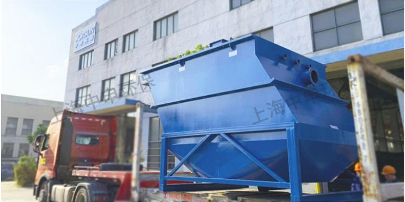
斜板式沉淀池工作原理是根据平流沉淀原理，在池内增设大量的斜管后，增大过水截面的湿周，减小了水力半径，因此在同一水平流速 $v$ 下，雷诺数 $re$ 很大降低，从而减少了水流紊乱，促进沉淀。另外，在泥渣漂浮层上方安装60度斜管组，使原水中的漂浮物、固化物或混凝形成絮状矾花，在斜管底侧表面聚集成薄泥泥层，再靠重力将泥渣悬浮层吸出，再沉入集泥斗，由排泥管排入污泥池进行处理或综合利用。上清逐渐上升至集水管排放，可直接排放或回用。斜板沉淀池批发厂家，欢迎咨询上海中申环境工程有限公司。浙江新型斜板沉淀池发展
